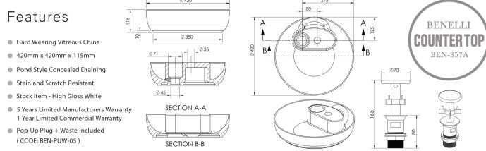
Overall Dimensions 420mm (w) x 420mm (d) x 115mm (h)
